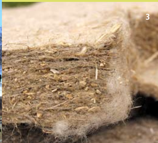
1, 3 | Naturizol je konopná přírodní izolace se lněným a jutovým vláknem 2 | Izolační schopnosti slámy a rákosu jsou vynikající 4 | Ovcí srst skvěle izoluje díky vodoodpudivému lanolinu
