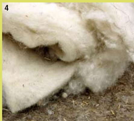
1, 3 | Naturizol je konopná přírodní izolace se lněným a jutovým vláknem 2 | Izolační schopnosti slámy a rákosu jsou vynikající 4 | Ovcí srst skvěle izoluje díky vodoodpudivému lanolinu
